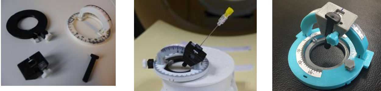
Fig. 1. Preparación del dispositivo de localización. A) Primer prototipo desmontado con los cuatro elementos fundamentales: base fija interior, corona móvil con arco en U, cabezal y adaptador para la aguja de biopsia. B) Prototipo montado sobre el maniquí finalizado. C) Último prototipo diseñado
